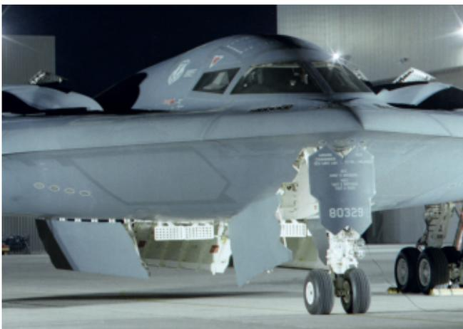
Sur cette photographie, nous voyons la trappe du train d'atterrissage avant en dent de scie ainsi que les panneaux des soutes à bombe. (Northrop)
