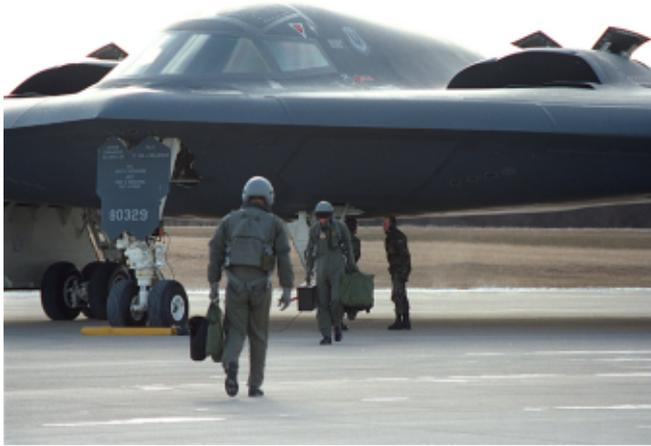
*Ci-dessus, les trappes d'entrées d'air situées au-dessus des réacteurs sont ici bien visibles. (Northrop)*
