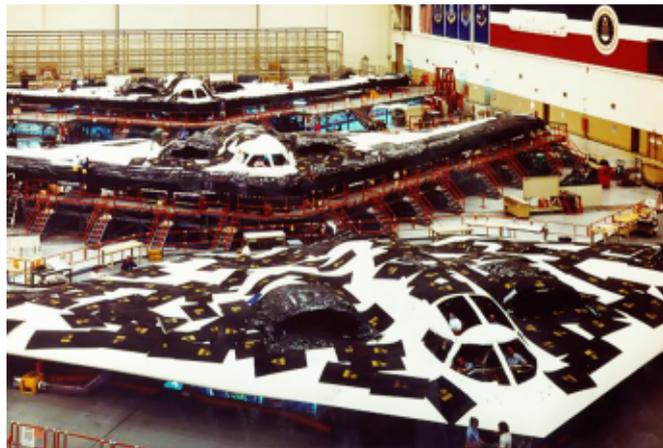
Rarissime photographie d'une chaîne de montage des B-2. (Northrop)
