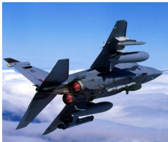
*Un Jaguar modernisé en 1993. Cette nouvelle version dispose en particulier de deux rails de lancement de missiles sur les extrados des ailes. L'électronique embarquée est améliorée par la présence d'un détecteur d'alerte radar, un nouvel IFF et un nouveau poste de radio crypté "Have Quick". Si les anglais modernisent leurs Jaguars il n'en va pas de même en France... (SW)*
